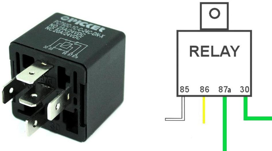
Los cables que controlan y comandan el corte de motor son el blanco conectado al terminal 85 y el amarillo conectado al terminal 86. Los cables que interrumpen el circuito de combustible o arranque son los verdes conectados a los terminales 87a y 30.
